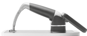
Fig. 2: visionPRO CS1 con el vídeo laringoscopio visionPRO insertado de forma errónea
